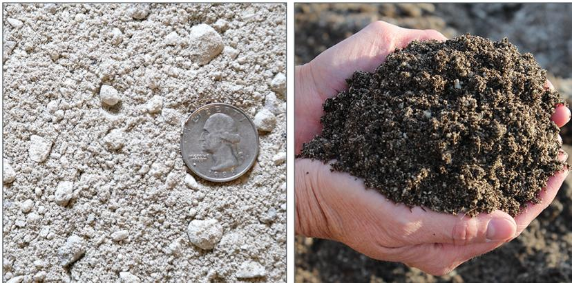
**Izquierda:** Finos de grado HP 3/8 MN\* (grado de mina) tiene un tamaño de piedra de extremo superior de 3/8 de pulgada con un amplio contenido de finos. **Derecha:** grado utilizado para modificar el suelo del jardín: resistir la compactación, mejorar la aireación de la zona de raíces, el drenaje y la retención de humedad.
