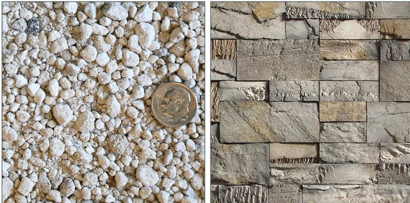
**Izquierda:** HP Grado 3/8 x #8 MN\* (grado de mina). **Derecha:** Grado utilizado como agregado en revestimientos ligeros de piedra, bloque y ladrillo.
